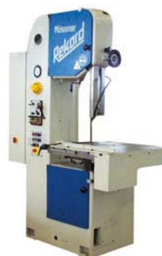
Máquina con mesa de avance Servomotor con husillo de rosca a bolas así como tope paralelo (Accesorio especial).
