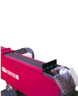
Superficies de lijado planas continuas para el mecanizado de piezas largas
