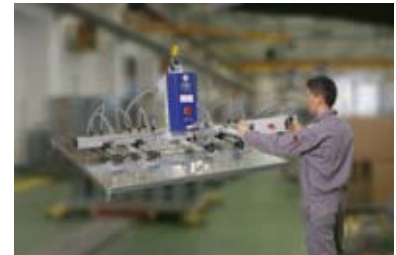
VacuMaster Comfort, 250 kg de capacidad de carga, giratorio en 90°
