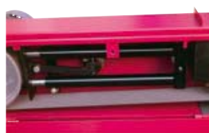
Brazo de sujeción doble para la sujeción exacta de la cinta abrasiva (libre de mantenimiento).
