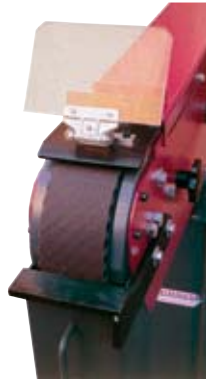
Cubierta completa, sin riesgo de lesiones
